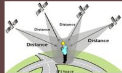
Er zijn minimaal 4 satellieten 'in het zicht' nodig om een positie te kunnen berekenen.
